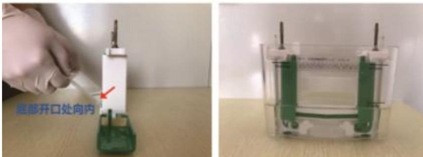
6. 向电泳槽的内槽中加入足量的 Tris/MOPS/SDS 电泳缓冲液，使电泳缓冲液浸没点样孔，并使液面停留在点样孔上方 5-7mm 处，接着在外槽中也加入足量的 Tris/MOPS/SDS 电泳缓冲液以确保适当的冷却，使用注射器或其它工具吸取适量 Tris/MOPS/SDS 电泳缓冲液，将点样孔轻轻冲洗干净，去除气泡和残留的储存缓冲液。将上样缓冲液处理后的蛋白样品加入点样孔，启动电泳。推荐电压为 160V，最高不超过 180V。
